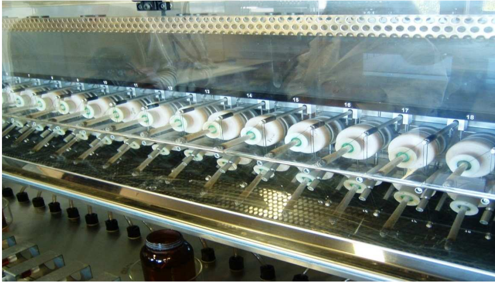
FIGURE 25 : MACHINE A FUMER UTILISEE POUR LES CIGARETTES ORDINAIRES, MAIS ADAPTABLES POUR ETRE UTILISEE DANS LE CADRE DE L'ETUDE DE LA « VAPEUR » DES E-CIGARETTES
