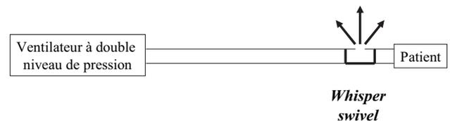
**Fig. 5.** Illustration schématique d'un circuit de ventilation monobranche avec fuite intentionnelle (raccord fenêtré, Whisper Swivel®). Cette fuite qui permet l'expiration du patient occasionne une déperdition de gaz au cours de l'insufflation. Ainsi, une accélération de la turbine du ventilateur permet d'atteindre la pression positive inspiratoire prédéterminée.
