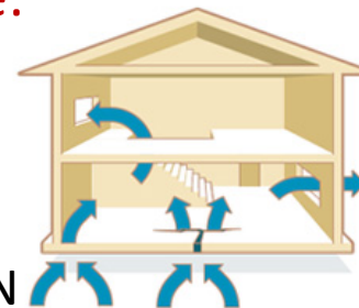
Aération des pièces habitées par ouverture des fenêtres.
