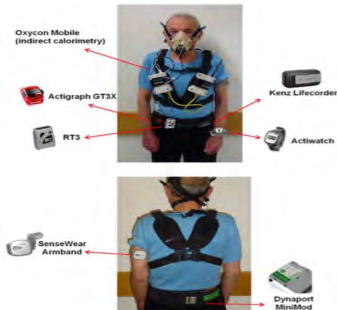
➤ Patients avec les 6 accéléromètres et appareil de mesure de  $VO_2$  mobile
