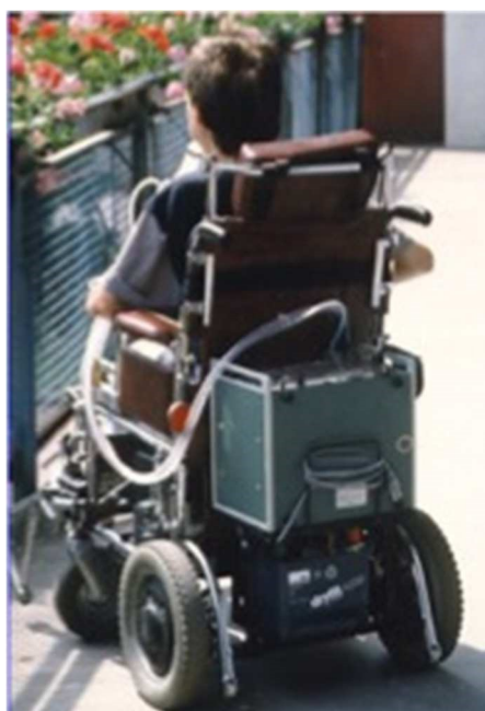
Fig 28: ventilateur embarqué à l'arrière du fauteuil électrique alimenté par sa propre batterie
