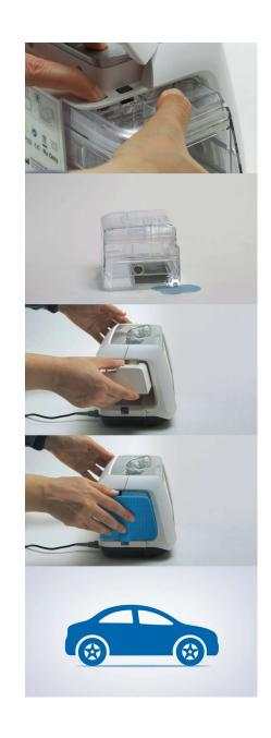
Pour retirer l'humidificateur, appuyer sur le bouton extérieur sur le côté gauche et tirer en même temps le réservoir de l'humidificateur délicatement vers l'extérieur.
