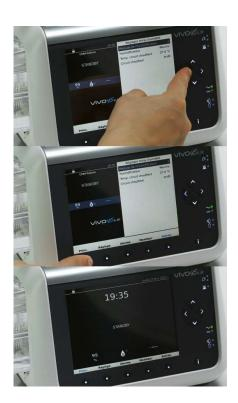
Puis sur la flèche de gauche pour diminuer la température ou sur la flèche de droite pour augmenter la température.
