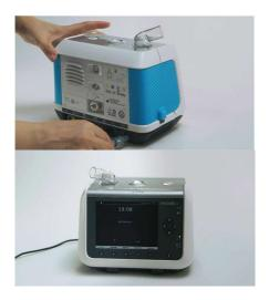
Connecter le câble d'alimentation au dos de l'appareil au niveau de la connectique grise, et brancher la prise sur le secteur.
