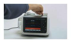
Vous pouvez inhiber l'alarme en appuyant une fois sur le bouton « Arrêt alarme » mais celle-ci sonnera de nouveau au bout de quelques minutes si le problème n'est pas résolu.
